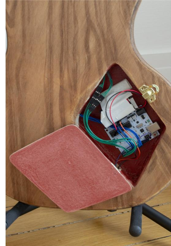
Si j'avais mieux réfléchi à la manière de souder les cables aux cordes, j'aurais sûrement pu les garder à l'extérieur du châssis et rendre le changement des cordes possibles sans démonter la guitare.
